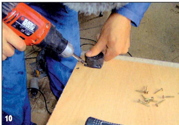
Каждая тумба установлена на четыре пластиковые регулируемые ножки. На них же крепятся на защёлках цокольные планки, закрывающие щель между тумбами и полом.
