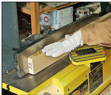
Пристрожка кромок заготовок перед склеиванием в щит.
