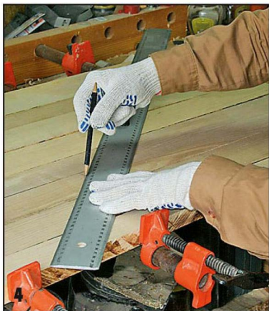
Чтобы не перепутать в процессе склеивания подобранные для щита заготовки, по диагонали прочертил линию.
