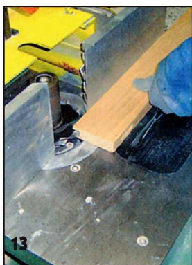
На фрезерном станке в кромках деталей рам выбрали канавки для филенок.
