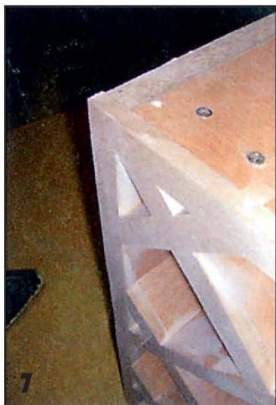
Фасад тумбы для бутылок Жерман решил сделать из букового мебельного щита. Он просто положил готовый шкаф на мебельный щит и обвёл по контуру все детали карандашом. Ну а дальше поработал лобзиком. Потом приклеил фасад и обработал шлифовальной машинкой.
