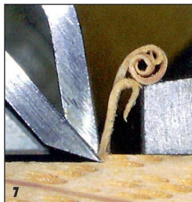
Строгание дубовой заготовки против волокон с очень низкой установкой стружколома.
