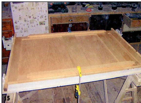
Собранные и склеенные дверные полотна уложили на ваймы и стянули.
