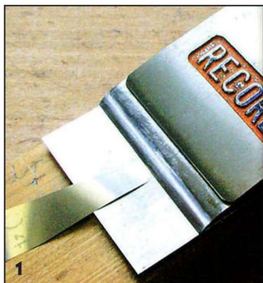
Самодельное приспособление для проверки подгонки стружколома под нагрузку прижима.
