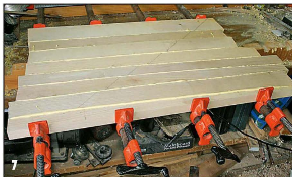
После нанесения клея щит стянул струбцинами.
