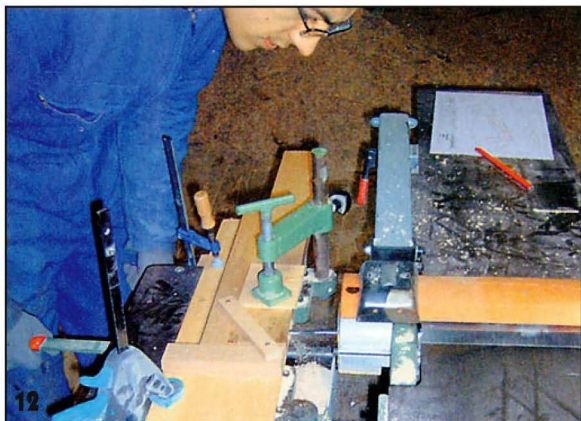
Для выборки пазов использовали долбежный станок. Он даёт возможность точно выполнить эту работу.
