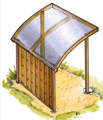
Рис. 2. Этот навес более компактен. В отличие от первого варианта, здесь осталась лишь одна стенка-ширма, а также одна половина крыши.
