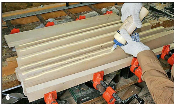
Нанесение клея на кромки склеиваемых заготовок.
