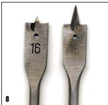
Чтобы сверло \varnothing 16 мм не проходило насквозь при сверлении глухого отверстия, у одного из них укоротил направляющий центр (слева — переточенное сверло, справа — стандартное).
